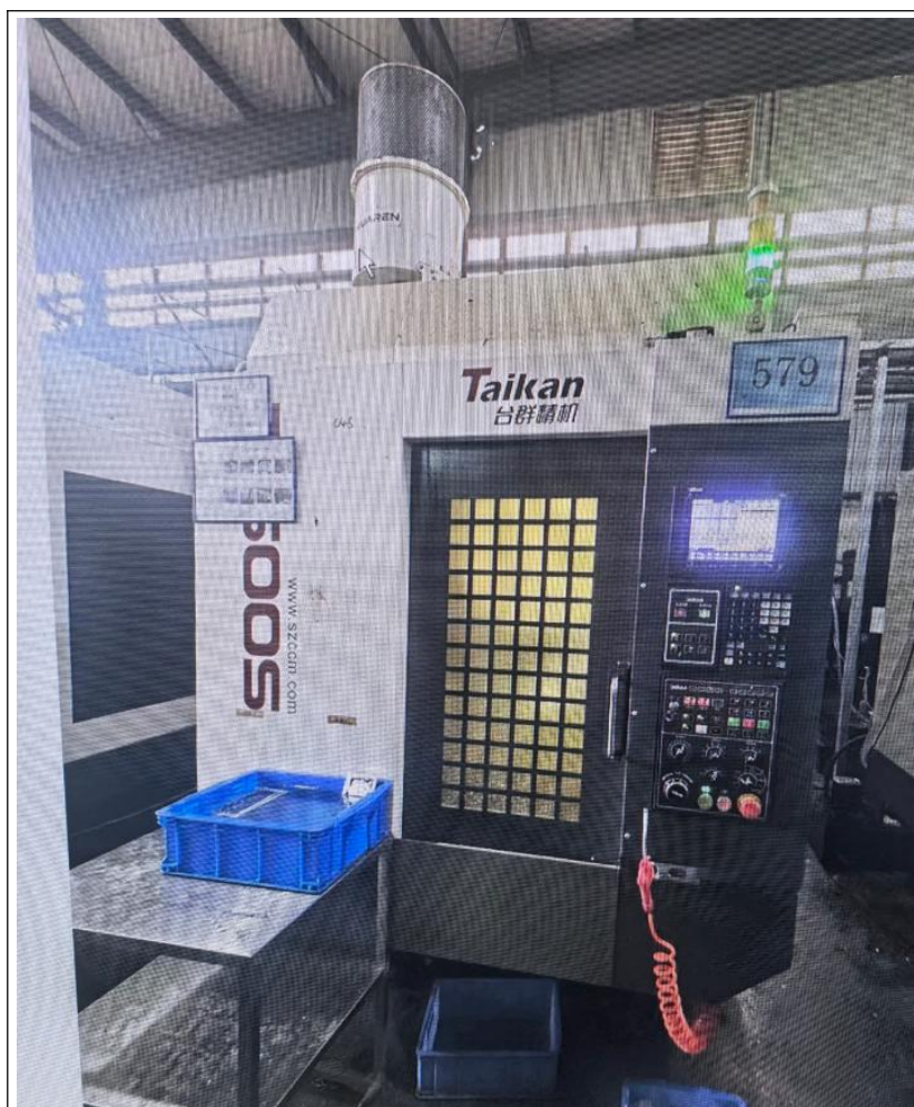
图3-11 离心式油雾收集处理器
