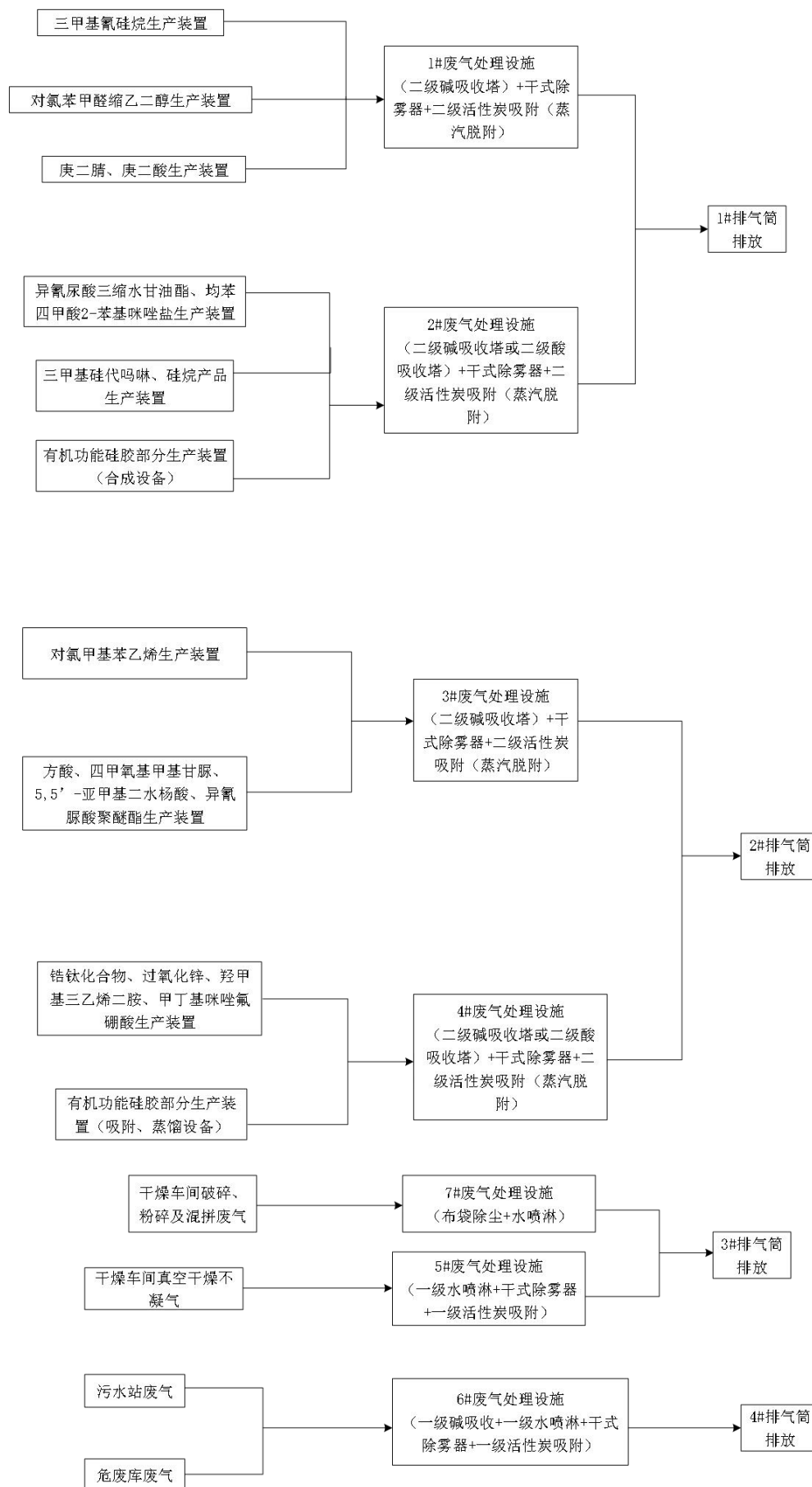
图4.1-4 全厂有组织废气处理工艺流程图
