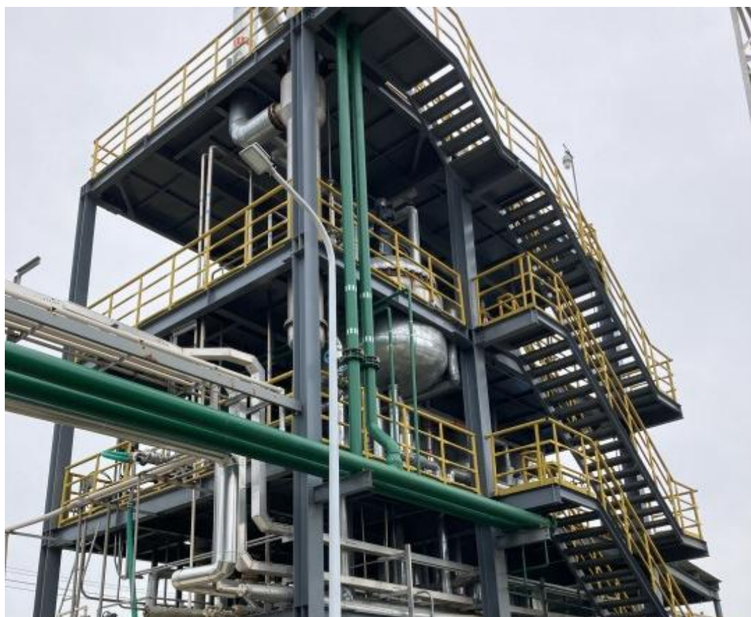
图 4.1-3 三效蒸发装置
